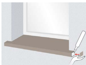
7_LEPLJENJE ZAVRŠETAKA NA KRAJEVE KLUPICA POMOĆU MONTAŽNOG LEPKA
