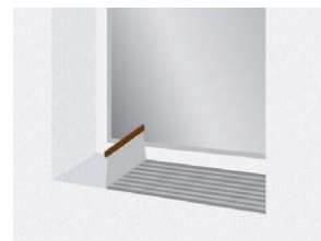
4_NANOŠENJE LEPKA ZA STIROPOR NA PODLOGU
